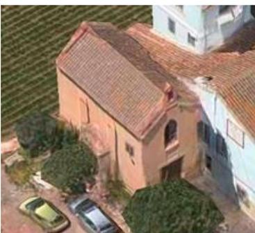
Respecto a la estructura de estas edificaciones, se caracterizan por constar de un único volumen normalmente rectangular con cubierta a dos aguas.
